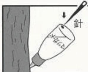
▲ボトルにマジックなどで薬液面に印を付けておくと吸収量がチェック出来ます。
