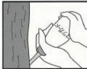
孔の空気を抜くため、容器の胴部分を2～3回強く押して下さい。
